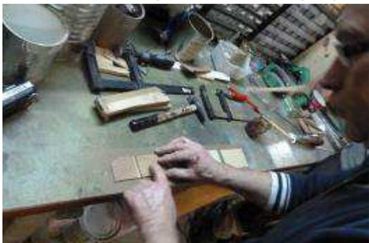
Fabrication d'une éprouvette pour vérifier la qualité d'un collage
