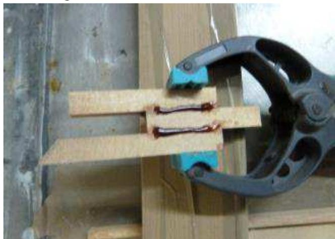
Réparation d'un impact sur un bord d'attaque
